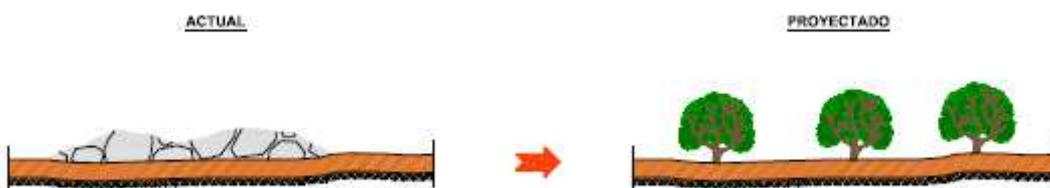
La tierra vegetal localizada bajo la superficie que será cubierta con el nuevo perfil para suavizar el conjunto final del nuevo volumen se retirará previamente y se acopiará para ser reutilizada posteriormente en las labores de integración ambiental de la escombrera.
